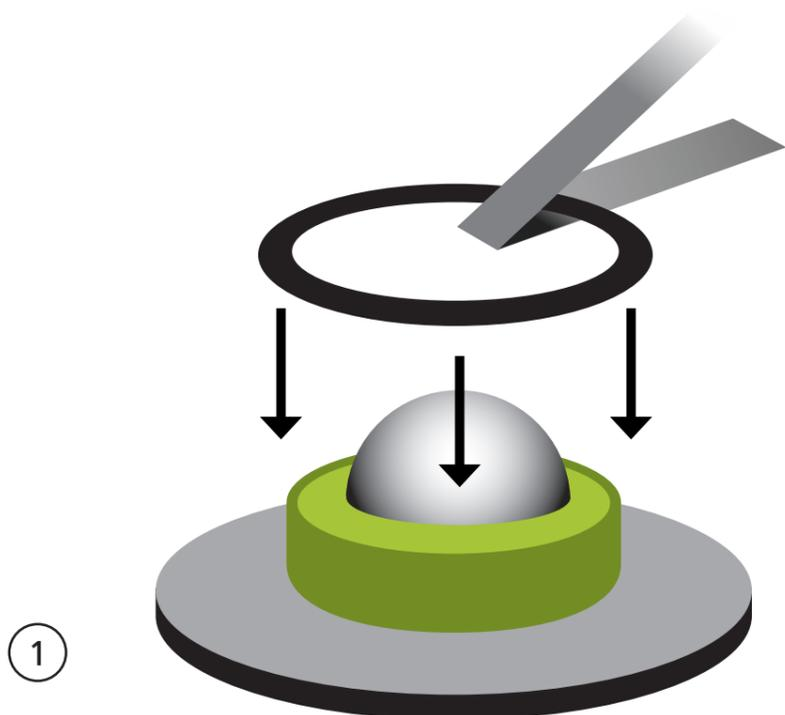
Führen Sie eine Seite des Bandes durch den Haltering und schließen Sie den Klettverschluss: Stülpen Sie den Haltering über die farbige Buchse mit der Kugel.
