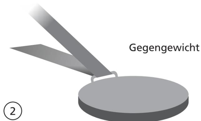
Die andere Seite des Klettbandes führen Sie durch die Metallöse des Gegengewichtes und verschließen wiederum den Klettverschluss.
